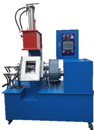
ภาพที่ 2.4 เครื่องนวดยางหรือนีดเดอร์ (kneader)
