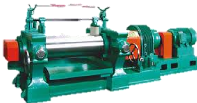
ภาพที่ 2.1 เครื่องผสมแบบ 2 ลูกกลิ้ง (two - roll mill) (ที่มา: หน่วยเทคโนโลยียาง, 2552)
